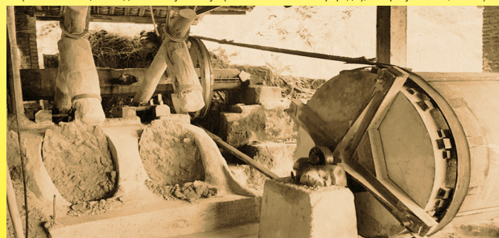
Традиционные механизмы (水確, шуй дуй) для производства порошков, используемых для изготовления электротехнического фарфора (частная коллекция)
